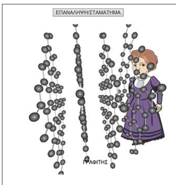
Εικόνα 4: Δομή του γραφίτη, όπου απεικονίζονται τα παράλληλα φύλλα του.
