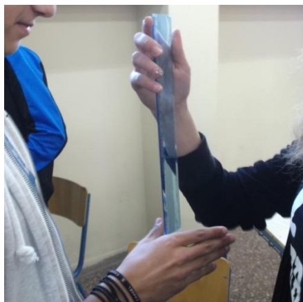
Εικόνα 2: Διάταξη χεριών και χάρακα στη μέθοδο αρπαγής
