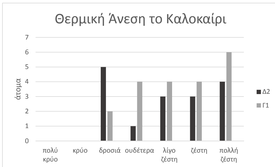
Εικόνα 22: Θερμική άνεση την καλοκαιρινή περίοδο στα δύο τμήματα υπό έρευνα
