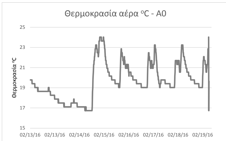
Εικόνα 5: Θερμοκρασία αέρα χειμερινής περιόδου αίθουσας Α0
