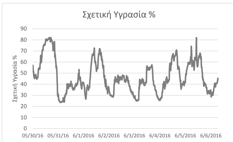
Εικόνα 14: Σχετική υγρασία εξωτερικού αέρα θερινής περιόδου
