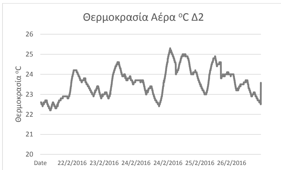
Εικόνα 4: Θερμοκρασία αέρα χειμερινής περιόδου αίθουσας Δ2
