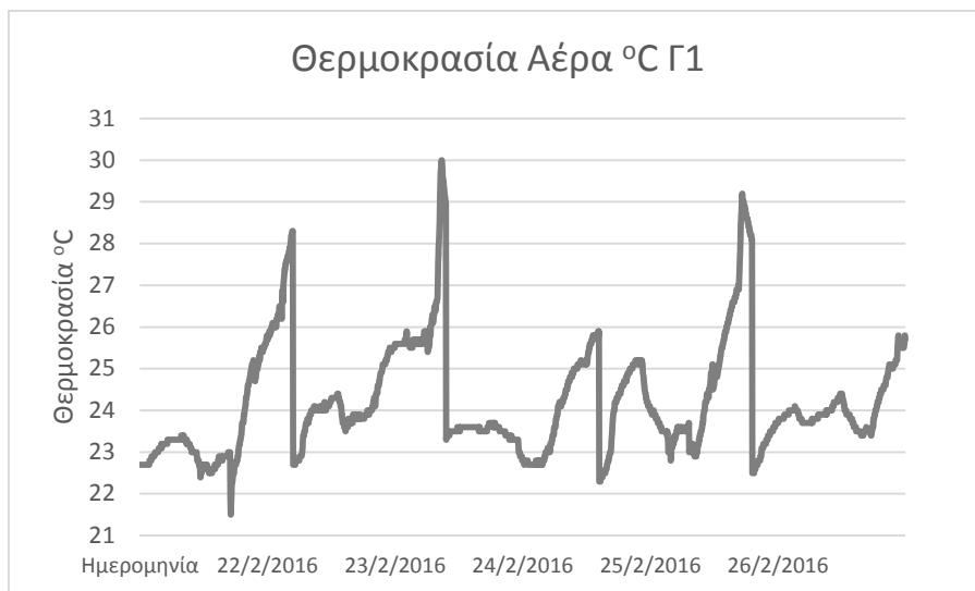
Εικόνα 3: Θερμοκρασία αέρα χειμερινής περιόδου αίθουσας Γ1
