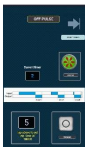
Εικόνα 6. Το panel OFF PULSE της εφαρμογής TimeR_SiM το οποίο προσομοιώνει ενός χρονιστή παλμού σε κατάσταση απενεργοποίησης
