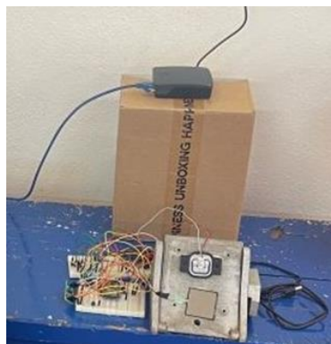
Σχήμα 2. Το σύστημα με το Raspberry Pi και τους αισθητήρες σε μπλοκ μπατήρα
