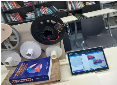
Εικόνα 6. Τοποθέτηση του μικροελεγκτή micro:bit στην περιφέρεια της τροχαλίας με σκοπό τη μελέτη της κυκλικής κίνησης
