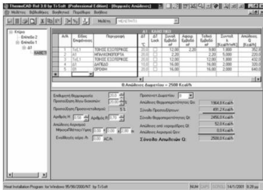
Εικόνα 7. Συνέχεια του λογιστικού φύλλου υπολογισμού θερμικών απωλειών του προγράμματος με τα υπόλοιπα πεδία συμπληρωμένα
