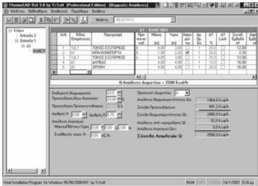
Εικόνα 6. Το λογιστικό φύλλο υπολογισμού θερμικών απωλειών του προγράμματος (χωρίς μόνωση των δομικών στοιχείων), με επί πλέον προσαυξήσεις α) λόγω διακοπών λειτουργίας, β) από χαραμάδες και την δυνατότητα ανανεώσεων του αέρα
