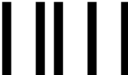
Σχήμα 3. Ο γραμμωτός κώδικας (barcode) που ενεργοποιεί το πρόγραμμα πορείας με παρακολούθηση γραμμής του Edison
