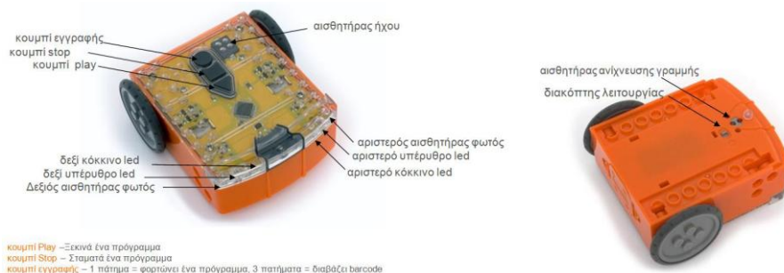
Σχήμα 1. Το ρομπότ Edison και χαρακτηριστικά στοιχεία του
