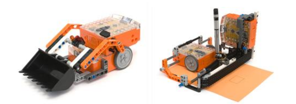
Σχήμα 5. Παραδείγματα ρομποτικών κατασκευών συνδυάζοντας δύο Edison ρομπότ και δομικά στοιχεία LEGO®: α) εκσκαφέας Edison - Lego και β)εκτυπωτής Edison - Lego
