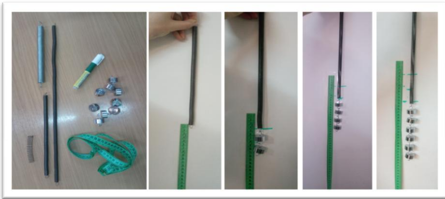
Σχήμα 6: Υλικά και διαδικασία δημιουργίας κλίμακας δυναμόμετρου
