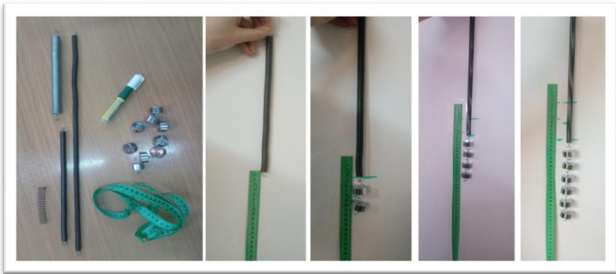
Σχήμα 6: Υλικά και διαδικασία δημιουργίας κλίμακας δυναμόμετρου
