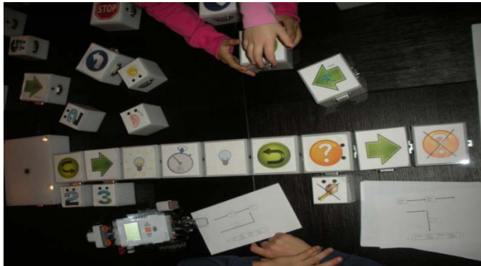
Σχήμα 1. Οι ενεργοί κύβοι στο σύστημα απτικής διεπαφής T_ ProRob
