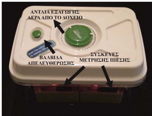
Σχήμα 2. Αεροστεγές δοχείο που χρησιμοποιείται στα πειράματα
