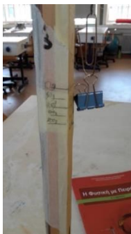
Εικόνα 1. Μετά από «δοκιμές» κρίθηκε σκόπιμη η επικόλληση χαρτοταινίας προκειμένου να σημειωθούν οι ενδείξεις της επιμήκυνσης του ελατηρίου και στη συνέχεια να μετρηθούν με την χρήση χάρακα.
