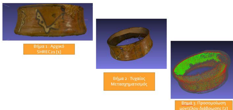
Εικόνα 3: Στην εικόνα εμφανίζονται τα διαφορετικά στάδια της δημιουργίας της συνθετικής μας βάσης. Στην τελευταία εικόνα παρουσιάζονται με διαφορετικό χρώμα τα διαφορετικά επίπεδα διάβρωσης. Με γκρι είναι το αρχικό μοντέλο, με κόκκινο ύστερα από 30 χρόνια τεχνητής γήρανσης και με πράσινο χρώμα εμφανίζεται το μοντέλο ύστερα από 60 χρόνια διάβρωσης.
