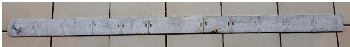
Εικόνα 1: Στη μεταλλική ράβδο έχουν τοποθετηθεί από 3 σταγόνες πηγμένου κεριού στα 10, 15, 20 και 25 εκ. εκατέρωθεν του κέντρου της
