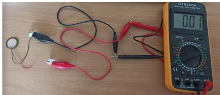
Εικόνα 2. Κύκλωμα πειραματισμού με το πιεζοηλεκτρικό στοιχείο και τη δημιουργία διαφοράς δυναμικού στα άκρα του
