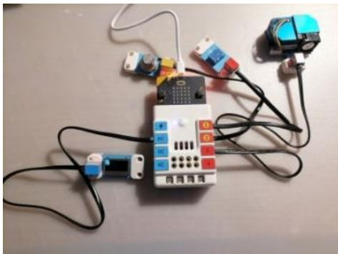
Εικόνες 1, 2: Διατάξεις Εκπαιδευτικής Ρομποτικής για την πραγματοποίηση πειραματικών μετρήσεων φαινομένων των Φυσικών Επιστημών.
