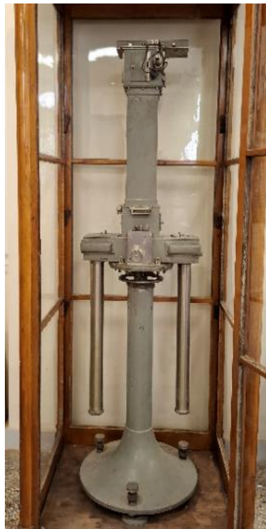
Εικόνα 4. Ο Ζυγός του Εϋθνός του Μουσείου ΦΕΤ και εικόνα του από κατάλογο της εταιρίας Askania-Gewerke AG
