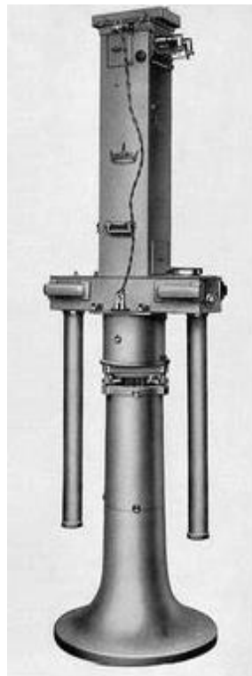
Εικόνα 4. Ο Ζυγός του Εϋθνός του Μουσείου ΦΕΤ και εικόνα του από κατάλογο της εταιρίας Askania-Gewerke AG
