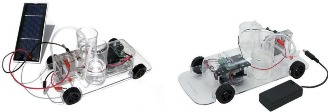
Εικόνα 4. Μοντέλο αυτοκινήτου υδρογόνου σε τροφοδοσία με ηλιακό πάνελ (αριστερά) και με μπαταρία (δεξιά)
