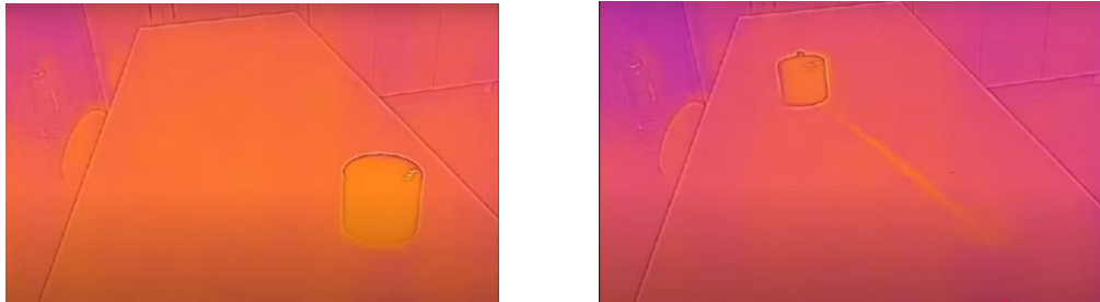
Εικόνα 1. Μεταβολή της θερμοκρασίας σε πάγκο εξαιτίας της τριβής ολίσθησης
