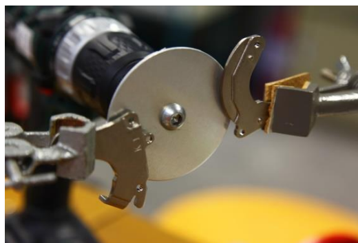
Εικόνα 6. Η προτεινόμενη διάταξη για το φαινόμενο Joule στα δινορεύματα
