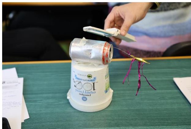
Εικόνα 3. Πείραμα φωτοηλεκτρικού φαινομένου με αυτοσχέδιο ηλεκτροσκόπιο και λάμπα UV-C
