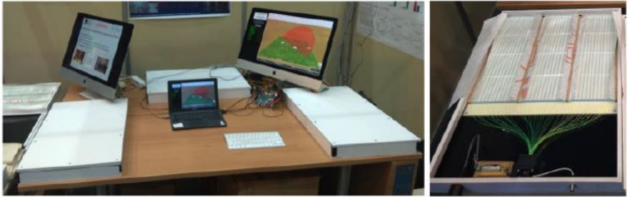
Σχήμα 3. Το τηλεσκόπιο μCosmics με 3 μονάδες ανίχνευσης (λευκά κουτιά) και το εσωτερικό τους (δεξιά).
