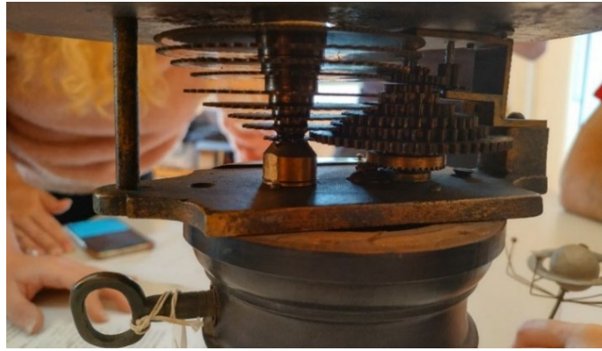
Εικόνα 7. Πλάγια όψη του πλανηταρίου όπου φαίνεται ο κεντρικός μηχανισμός περιστροφής του με γρανάζια
