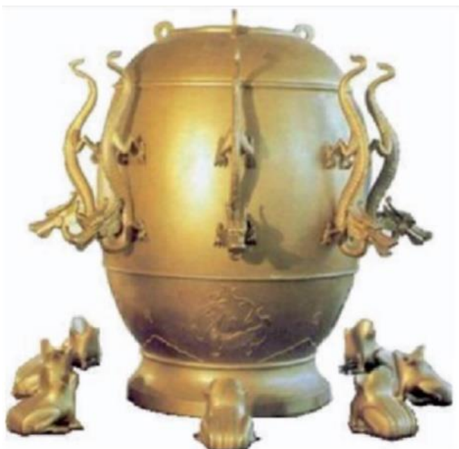
Εικόνα 1. Αναπαράσταση του σειμοσκοπίου Zhang Heng, βασισμένη σε σχέδιο του Wang Zhen-duo. Φωτογραφία στο βιβλίο του Hong-Sen, Y., (2007).
